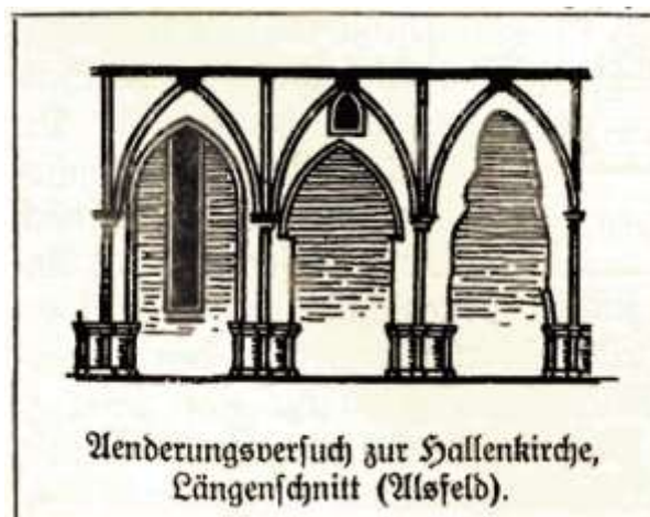
Änderungsversuch zur Hallenkirche Längenschnitt
